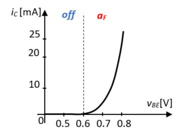
$$i_B = \frac{I_S}{\beta} e^{\frac{v_{BE}}{V_T}} \qquad i_C = \beta i_B \qquad i_C = I_S e^{\frac{v_{BE}}{V_T}}$$
