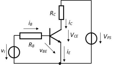
$i_{C} = \beta i_{B}$  $v_{CE} = V_{PS} - R_{C} \cdot i_{C}$
