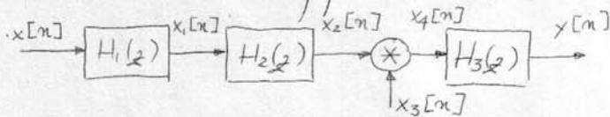
Blocurile  $H_1(z)$ ,  $H_2(z)$  și  $H_3(z)$  sunt trei SDLIT, având funcțiile de transfer:
